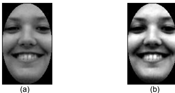
Figura 4: (a) Imagem após a normalização geométrica; (b) Imagem após a normalização de iluminação
